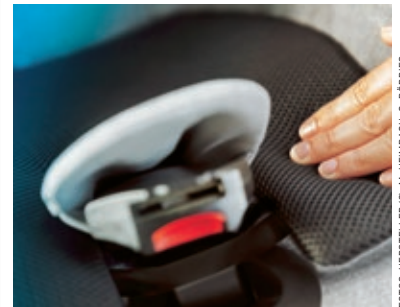
Weiche Matten für Kindersitze melden dem Fahrer, wenn er das Kind vergisst
