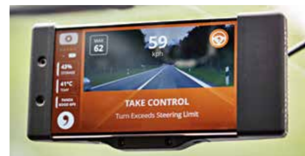
▲ Das System fordert den Fahrer (leider noch nicht zuverlässig) optisch und akustisch zum manuellen Eingreifen auf
