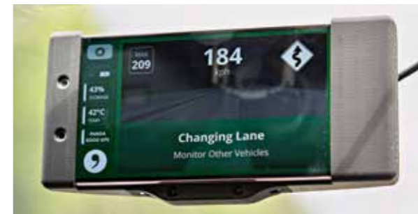
▲ Selbst bei hohem Tempo funktioniert der Spurwechselassistent. Ob frei ist, muss aber der Fahrer checken
