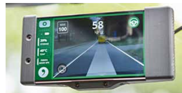
▲ Berechnete Fahrspur, vorgewählte und momentane Geschwindigkeit werden vom System gut sichtbar angezeigt
