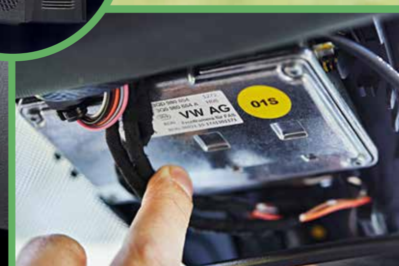
Das Openpilot-Modul muss fest unterhalb des Innen spiegels angeklebt werden
