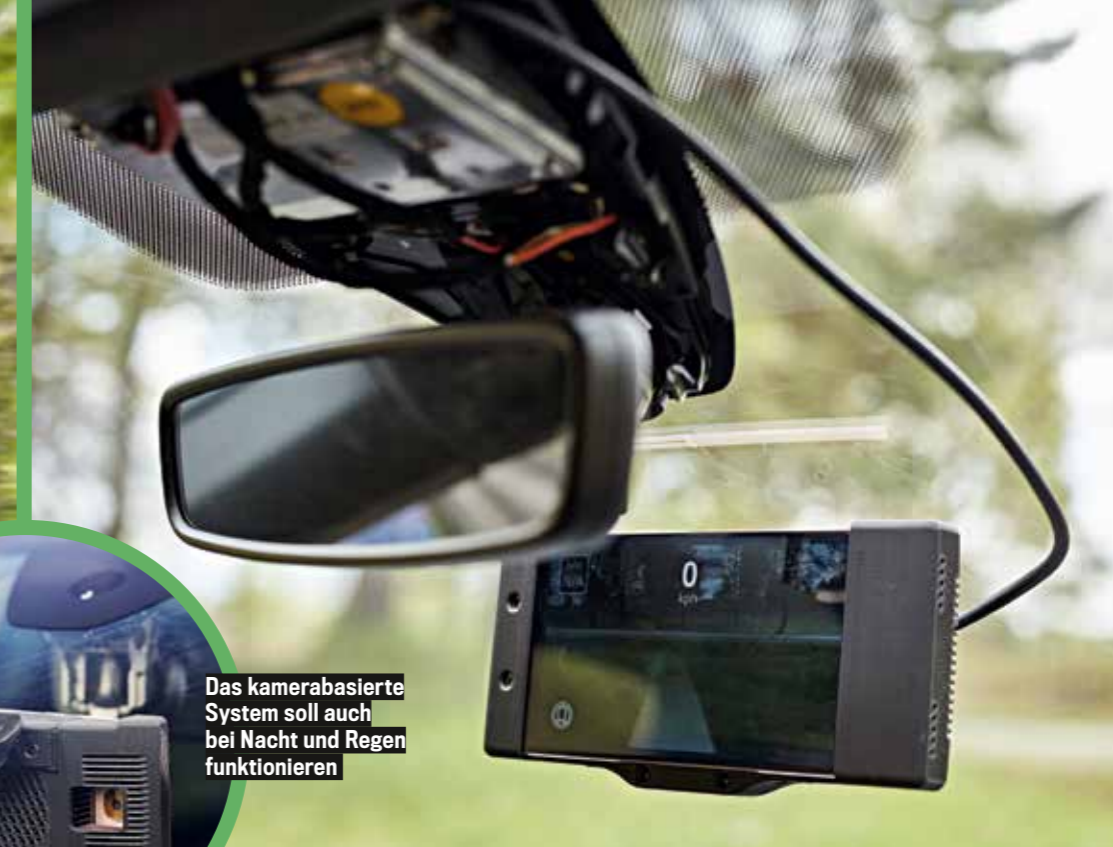
Das Openpilot-Modul muss fest unterhalb des Innen spiegels angeklebt werden
