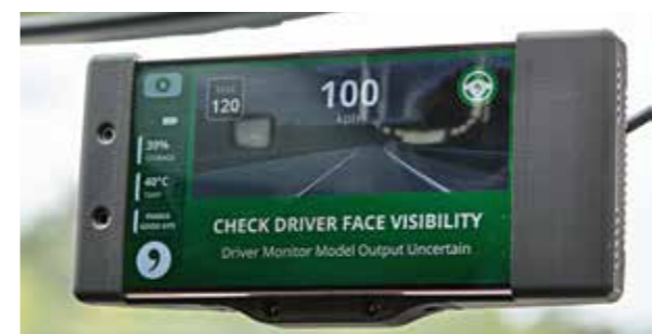
▲ Das System überwacht die Aufmerksamkeit des Fahrers und meldet sich, wenn es das Gesicht nicht erkennt
